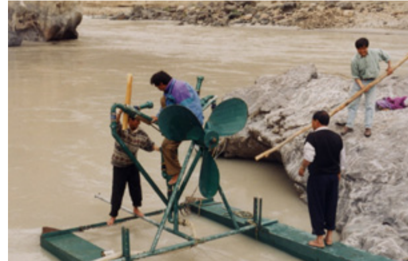
Dreikolben-Flusspumpe von der Hunte nach Vietnam
