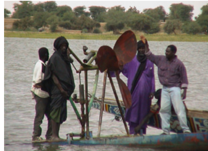
Flussgetriebene BORDA-Pumpe in Mali, 2000
