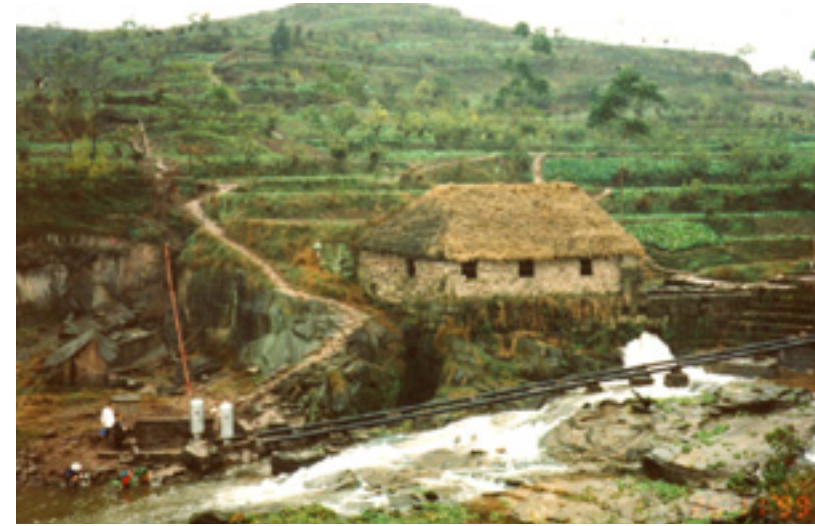
Hydraulische Widder pumpen Wasser auf hochgelegene Felder
