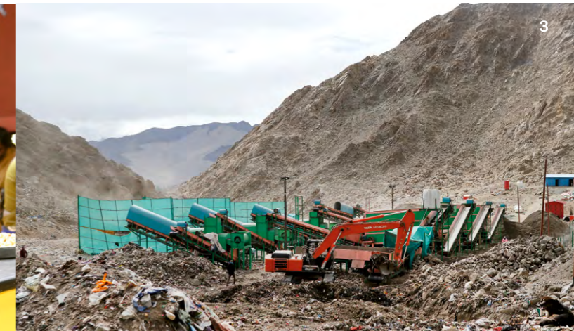
3 Sanierung von 100.000 Tonnen Altmüll in Leh, Indien: Der Abfall - verteilt über eine Fläche von 24 Hektar - wird getrennt in wieder verwertbare und nur noch zu entsorgenden Abraum. Nach der Sanierung wird das Land für die Entwicklung von Regierungseinrichtungen und öffentlichen Räumen zur Verfügung gestellt.
