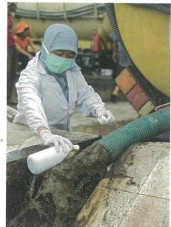
Entnahme von Fäkalschlamm für Labortest (Banda Aceh, Indonesien) (alle Fotos: BORDA WESCA)
