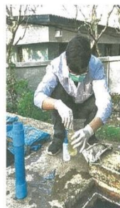
Wasserprobe-Entnahme DEWATS in Laos.
